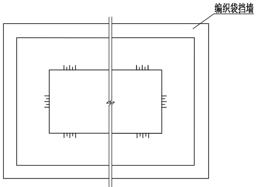
临时堆土防护措施平面图示意图
