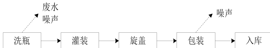
图 2-4 瓶装水灌装生产线工艺流程及产污环节图
