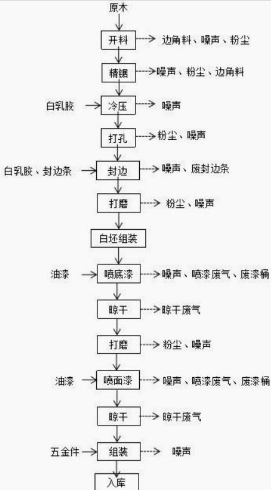
图 2-8 实木家具生产工艺及产污流程图
