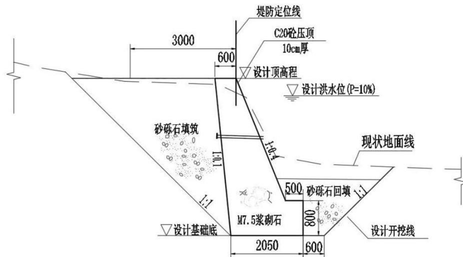
图 2-1 仰斜式浆砌石挡墙横断面图
