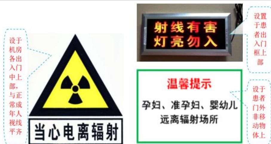
图 10-1 警示设施样例图
