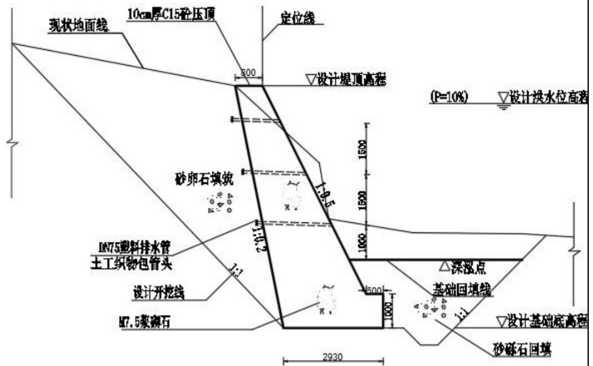
图 2-1 浆砌石仰斜式挡墙结构图
