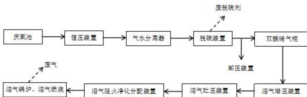
图 3.2-4 沼气利用流程及产污环节图
