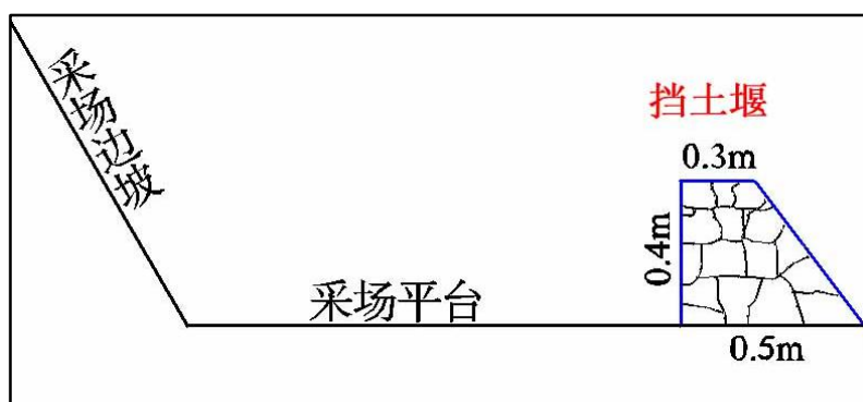
0.8m，深度 0.5m，底宽 0.3m。 图 5-5 开采终了境界截排水渠设计图
